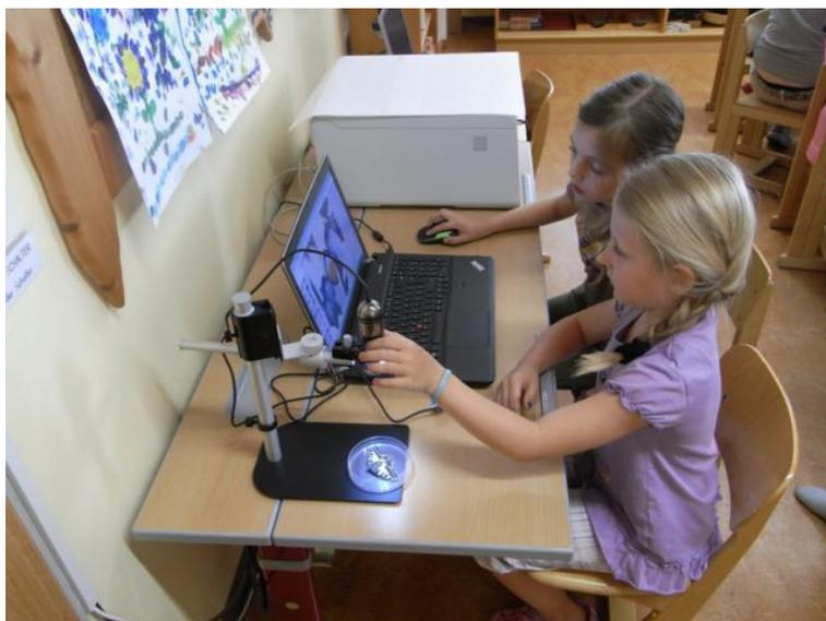
Auf einem normalen Schülertisch steht ein Durchlicht-Mikroskop (Leica DM300 Binokular, 40- bis 1000-fache Vergr.), das vor allem die älteren Kinder aus der Unverbindlichen Übung anspricht, da die Präparation von Untersuchungsobjekten doch einige Geduld erfordert.
